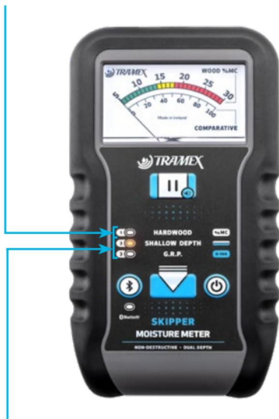
Skala 2 und 3 besitzen eine voreingestellte Empfindlichkeit, die an die Dichte von G.R.P. angepasst ist.
