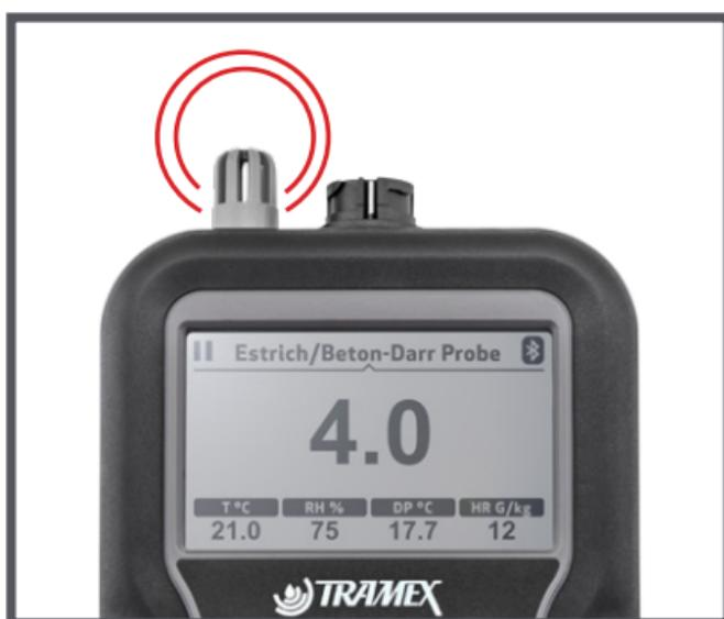
Im **Modus Ausgleichsfeuchte/Relative Luftfeuchte** ermittelt der Concrete Moisture Encounter X5 die elektrische Kapazität des RF-Fühlers, die von der relativen Feuchte der Prüfumgebung abhängt. Auf dem Concrete Moisture Encounter X5 wird die elektrische Kapazität als relative Luftfeuchte in Prozent angezeigt. Darüber hinaus misst das Gerät die Temperatur und zeigt den Taupunkt sowie den Feuchtegrad an.
