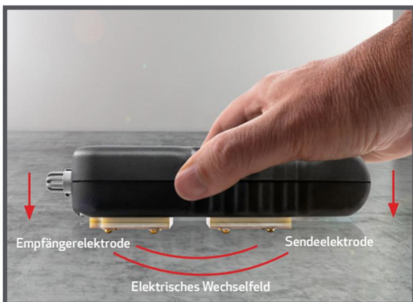
Das Wechselfeld durchdringt das geprüfte Material. Der sehr geringe Wechselstrom, der durch das Feld fließt, verhält sich umgekehrt proportional zur Impedanz des Materials. Das Gerät erfasst diesen Strom, bestimmt dessen Amplitude und kann somit den Feuchtegehalt ableiten.
