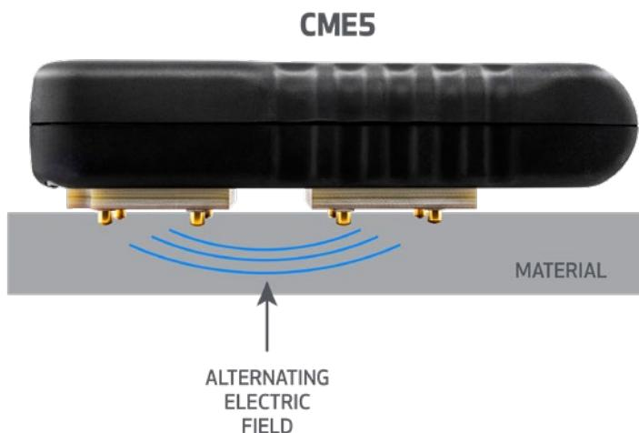
Ce champ pénètre le matériau testé. Un très faible courant alternatif circule à travers ce champ. Le Concrete Moisture Encounter CME5 détecte ce courant, en détermine l'amplitude et la convertit en une valeur de teneur en humidité. En appuyant simplement le Concrete Moisture Encounter CME5 sur la surface à des emplacements choisis de manière stratégique, des relevés instantanés peuvent être effectués sur une grande surface dans le laps de temps le plus court possible.
