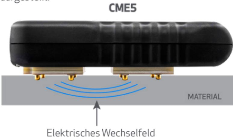
Dieses Feld durchdringt das zu prüfende Material. Durch das Feld fließt ein sehr kleiner Wechselstrom. Das Feuchtigkeitsmessgerät CME5 erkennt diesen Strom, ermittelt seine Amplitude und wandelt ihn in einen Feuchtwert um. Durch einfaches Herunterdrücken des Feuchtigkeitsmessgeräts CME5 auf die Oberfläche an strategisch ausgewählten Stellen können in kürzester Zeit Sofortmessungen über eine große Fläche vorgenommen werden.
