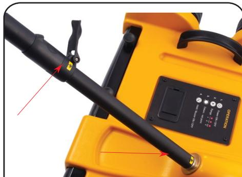
4. Asegúrese de que la "etiqueta de flecha" está centrada para que la comunicación por infrarrojos entre la unidad base y el medidor del panel de control sea óptima. Cierre y bloquee el mecanismo de cierre (flip-lock).
