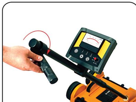
5. Ajuste la pieza de mano a la posición deseada, derecha o izquierda.
