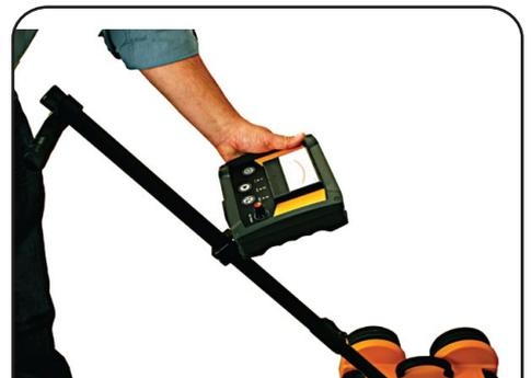
6. Enganche el medidor del panel de control en el soporte del medidor.
