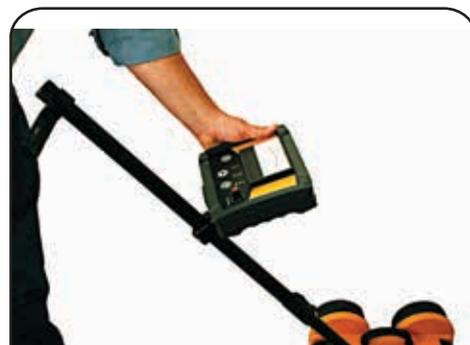
**6.** Agganciare il Contatore del Pannello di Controllo sul supporto per il contatore.
